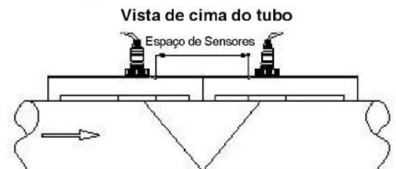
Figura 7: Método de Montagem V dos Transdutores
