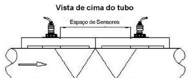
Figura 9: Método de Montagem W dos Transdutores
