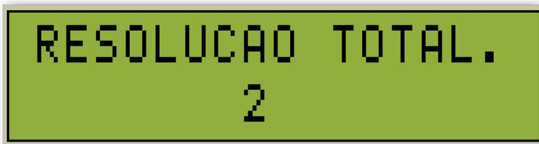
Estando na tela de **Resolução Total** para alterar apenas pressione o botão incremento, ao chegar ao valor desejado pressione o botão **ação** (✓) para confirmar, isto te levará a tela **Medição de Vazão**.
