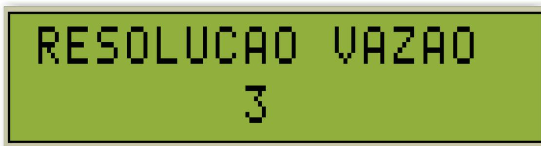
Estando na tela de **Resolução Vazão** para alterar apenas pressione o botão incremento (▲), ao chegar ao valor desejado pressione o botão ação (✓) para confirmar, isto te levará a tela **Resolução Total**.
