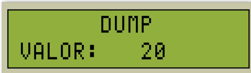
Nesta tela o usuário deve utilizar os botões de incremento e decremento para alterar o valor do Dump e pressionar o botão de **Ação** (✓) para confirmar a operação, isto o encaminhará para a tela de **Medição de Vazão**.
