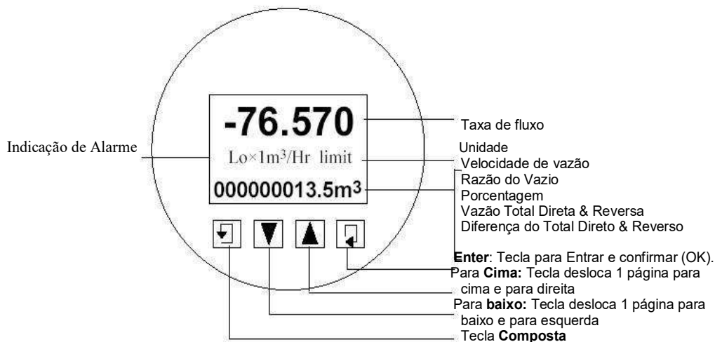
Figura 7.1.2 Definição do Teclado do Display LCD do Medidor Redondo
